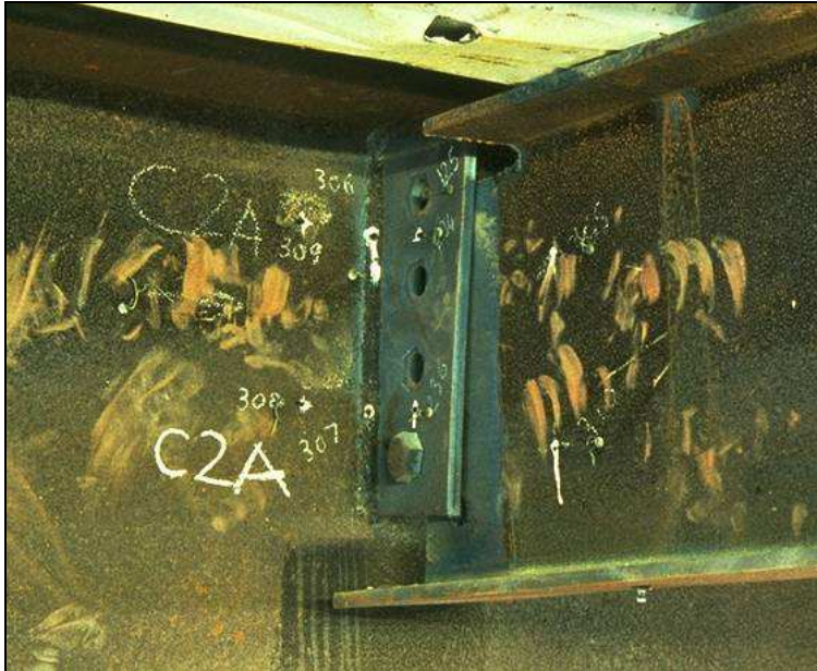
Figura 2.8 Unión de cartelas tras el ensayo
