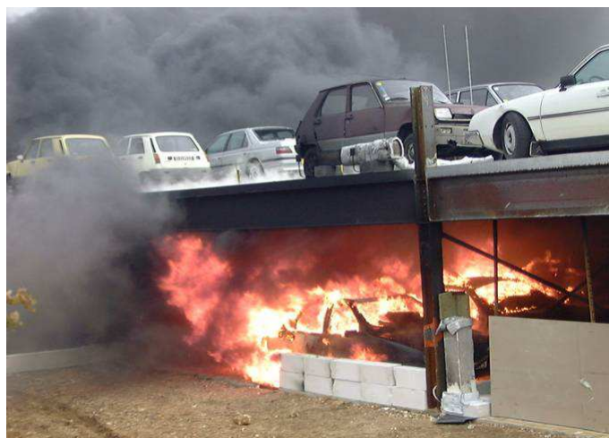
Figura 3.3 Desarrollo completo del fuego durante un ensayo de fuego
