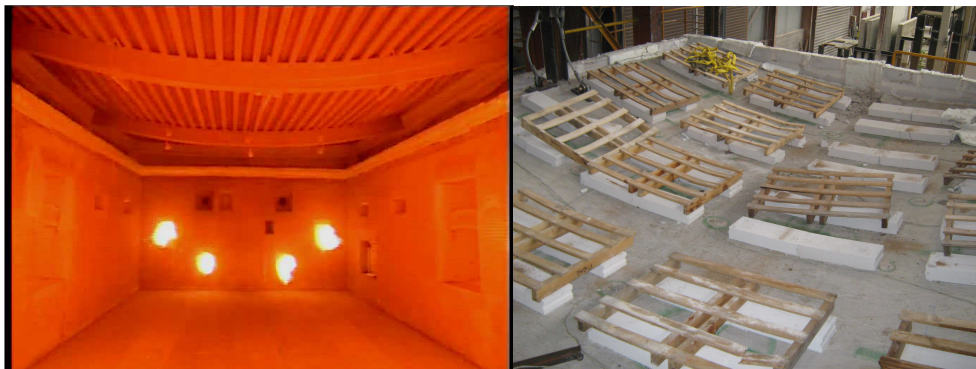
Figura 7.38 Forjado ensayado durante y después del fuego
